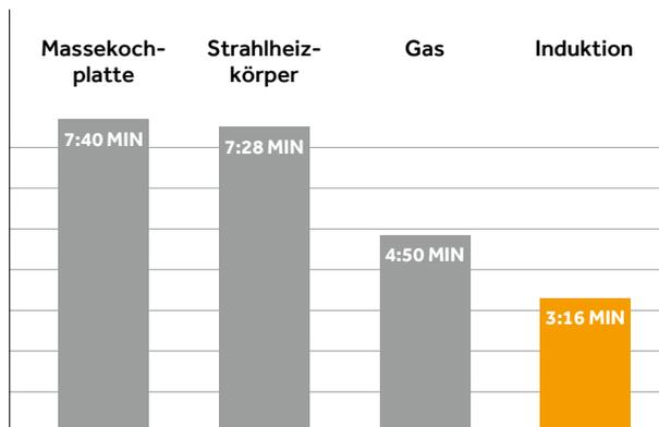
**Zeit** zur Erwärmung von 1,0l Wasser mit Stahl-Emailtopf (DIN 180, 18 cm Ø) auf 18er-Zone von 18°C auf 98°C
